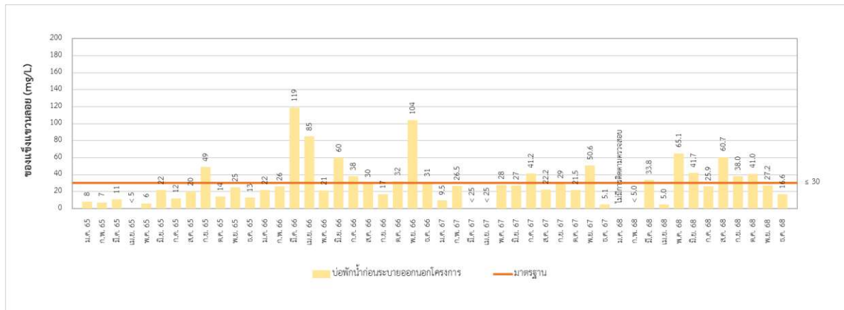
บ่อบำบัดน้ำก่อนระบายออกนอกโครงการ : ของแข็งแขวนลอย
