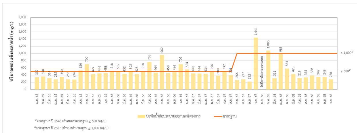
บ่อบำบัดน้ำก่อนระบายออกนอกโครงการ : ปริมาณของแข็งละลายน้ำ
