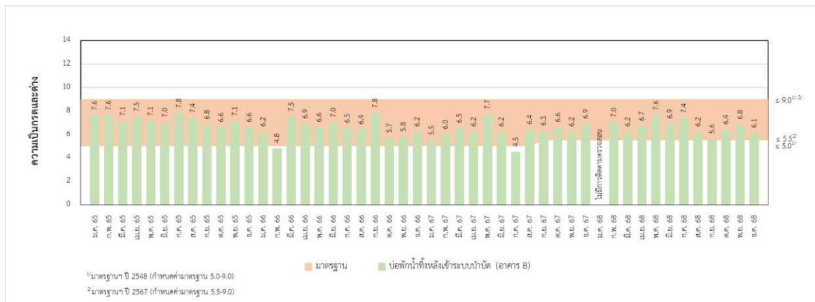
บ่อพักน้ำทิ้งหลังเข้าระบบบำบัด (อาคาร B) : ความเป็นกรดและด่าง
